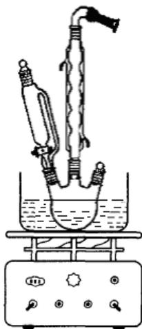
图1 磁力搅拌回流反应装置
